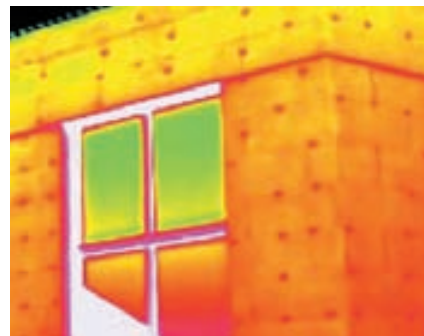
Tepelné mosty při použití klasického hmoždinkování (termografické zobrazení).
